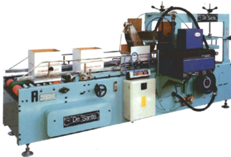
AM 85: Машины для склеивания картона «американского» типа
